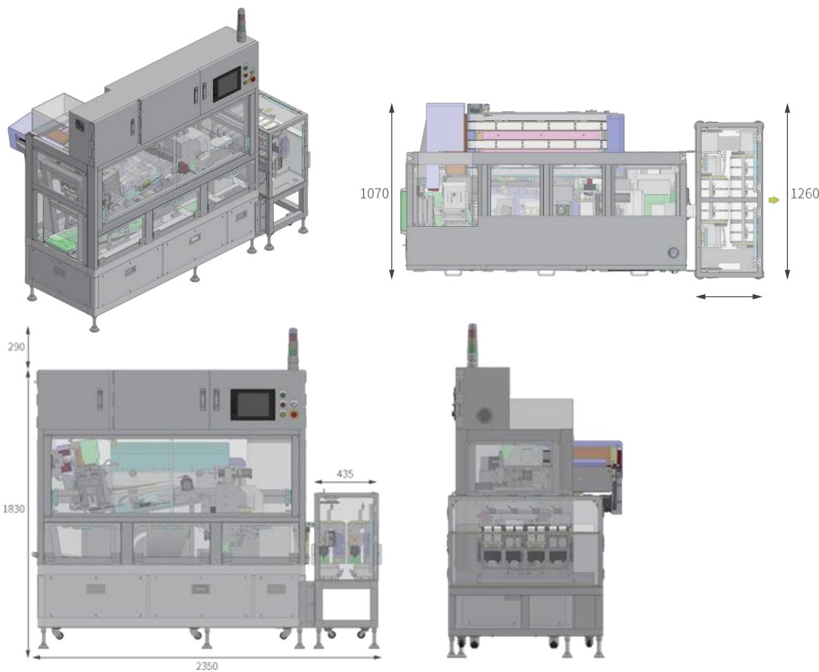
**MSU-L** ※MSU-Lは、MSUと寸法は同サイズで、タッチパネル、パン投入部のみ逆側になります。
